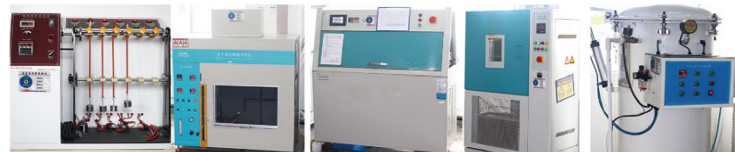
线材弯折试验机 水平垂直燃烧试验仪 淋雨试验箱 高低温检测仪 IPX8潜水试验装置
