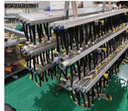
▲ AI液冷数据中心管路装配
